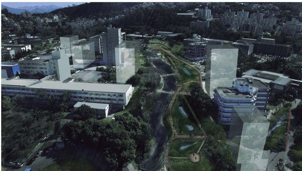
**Figura 0** Propuesta de ampliación del canal para absorber el agua en épocas de lluvia, depuración de las aguas y creación de parques en las áreas de protección de los arroyos. Fuente: Laboratorio de Ecología Urbana (UFSC). Fotografía de Felipe Finger.
